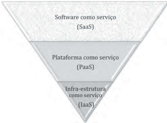
Figura 5 - Arquitetura em três camadas para a computação na nuvem
