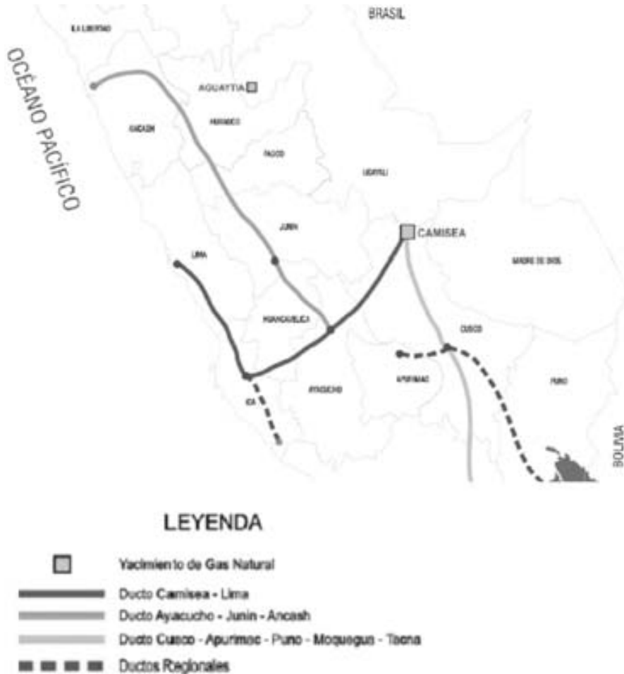
Figura 5. Gasoductos Instalados y en Desarrollo
